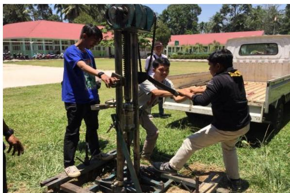
Gambar .6 Proses Pengerjaan Alat Sondir
