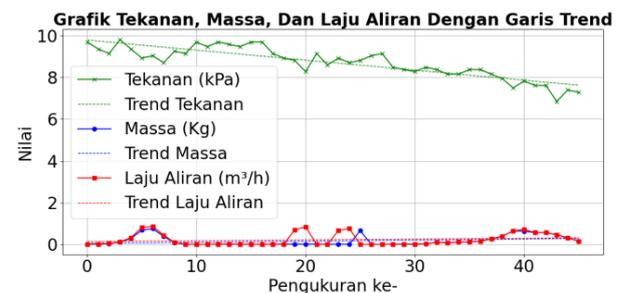
Gambar 4. Grafik Hasil Pengukuran Tekanan Dan Laju Aliran Biogas
